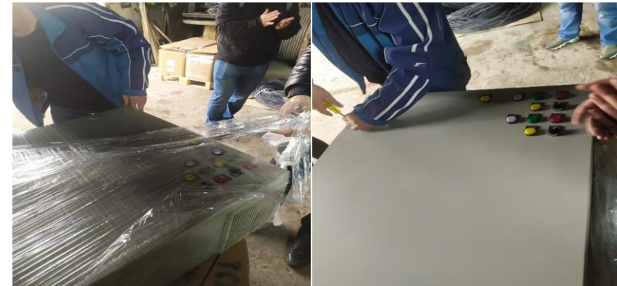
Шкаф управления с преобразователями частоты для управления электродвигателями насосных агрегатов мощностью 18,5 кВт
