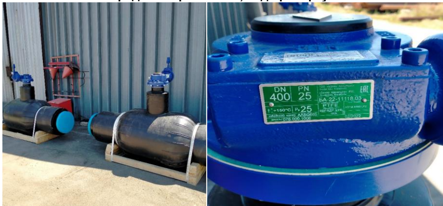
Шаровый кран PN25, DN100 полнопроходной, предизолированный, под приварку
