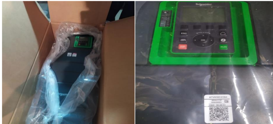
Преобразователь частоты для управления электродвигателем насосного агрегата мощностью 75, 90, 220 и 315 кВт
