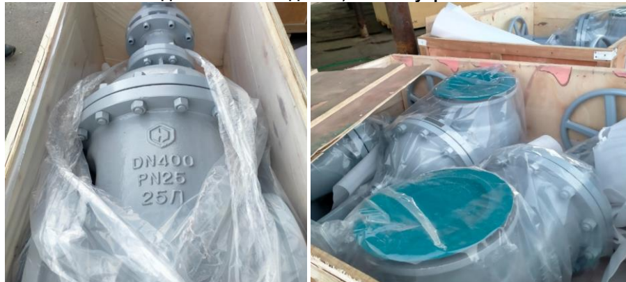
Задвижка клиновая DN250 PN25 и DN400 PN25, литая, под приварку, с выдвигаемым шпинделем, способ управления
