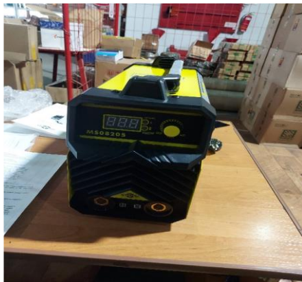
Инвентор сварочный, Напряжение-220В, макс.сварочный ток до 200А
