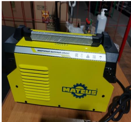
Инвентор сварочный, Напряжение-220В, макс.сварочный ток до 200А
