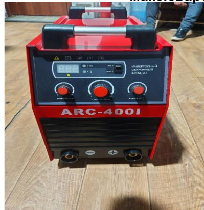
Инвентор сварочный, Напряжение-380В, макс.сварочный ток-400А
