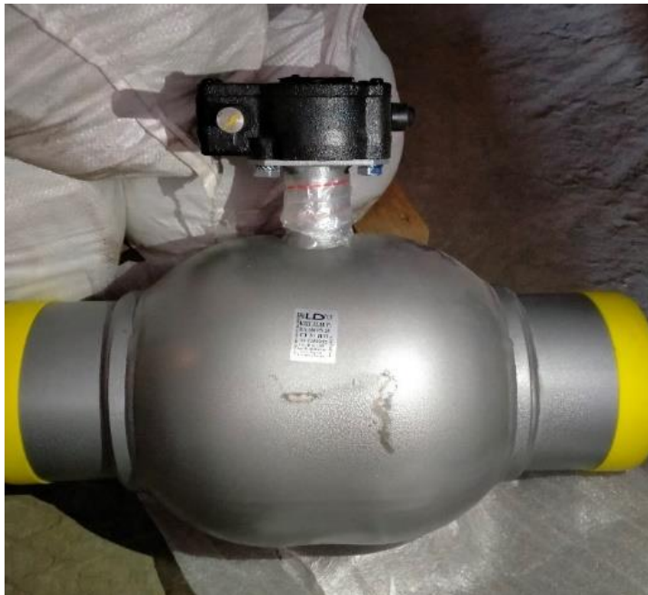
Шаровый кран PN25, DN150 полнопроходной, предызолированный, под приварку, способ управления – механический редуктор
