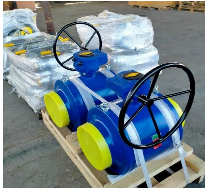
Шаровый кран PN25, DN 300, полнопроходной, под приварку, способ управления -механический редуктор
