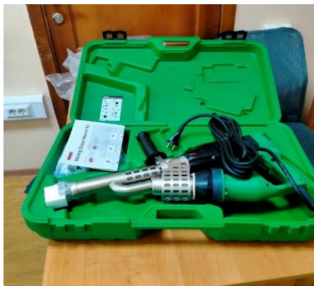
Экструдер ручной с аналоговой регулировкой
