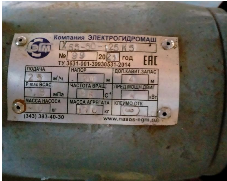
3. Агрегат насосный центробежный консольный химический. Подача, м 3 /ч-25; Напор, м-20.
