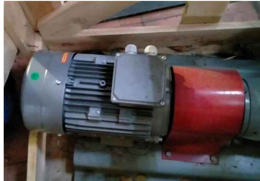
3. Агрегат насосный центробежный консольный химический. Подача, м 3 /ч-25; Напор, м-20.
