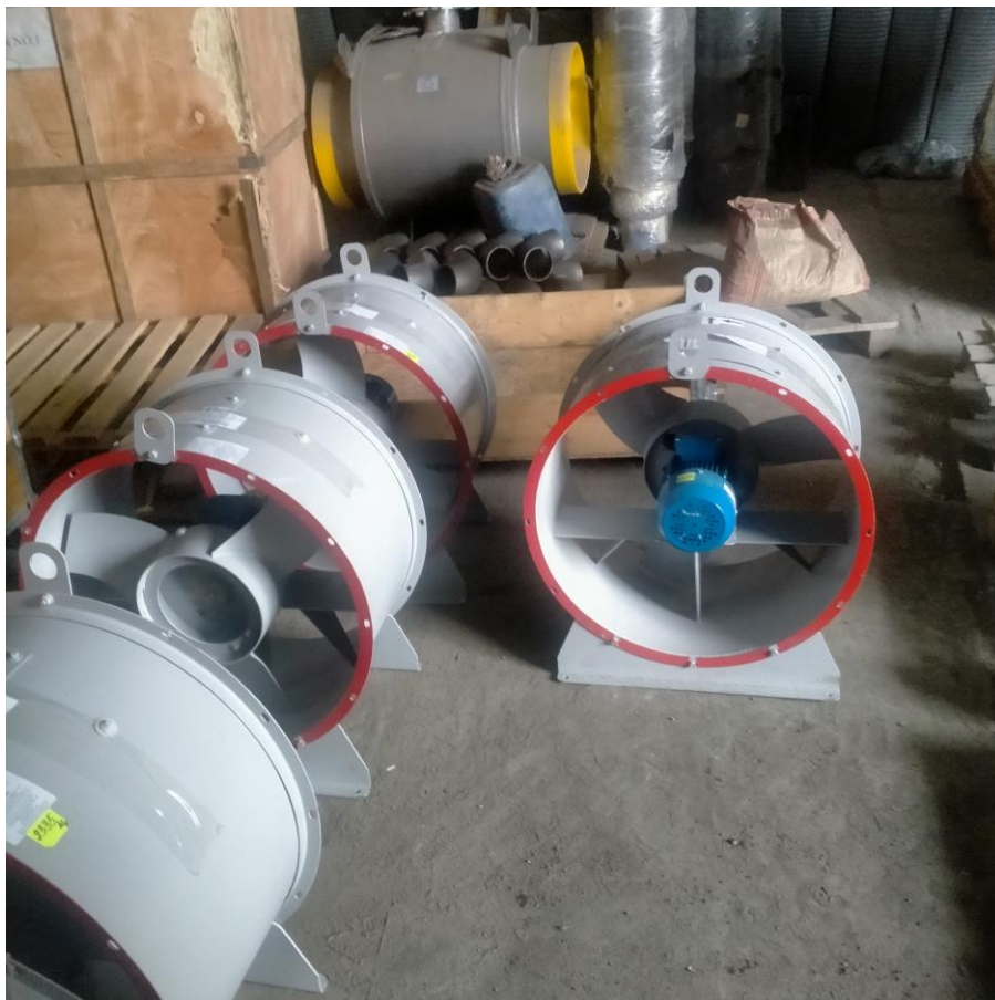
Насосы, вентиляционное и сварочное оборудование, электродвигатели 6. Вентилятор осевой общего назначения из углеродистой стали №6.3, 1.1кВт
