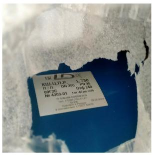
**Запорная арматура**3. Компенсаторы сильфонные DN 125, 150, 250, 300
