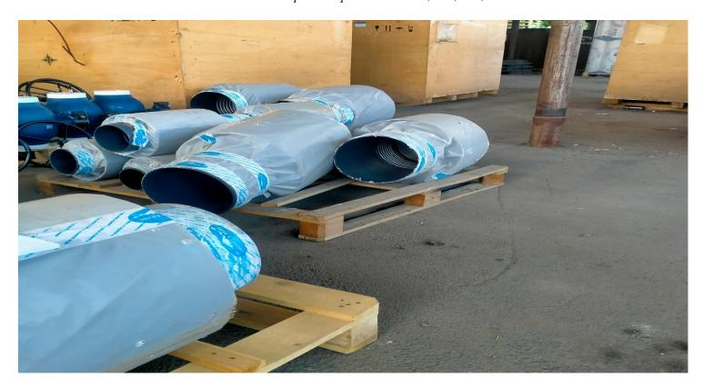
Запорная арматура 4. Виброкомпенсатор сильфонный PN16, DN100, 125
