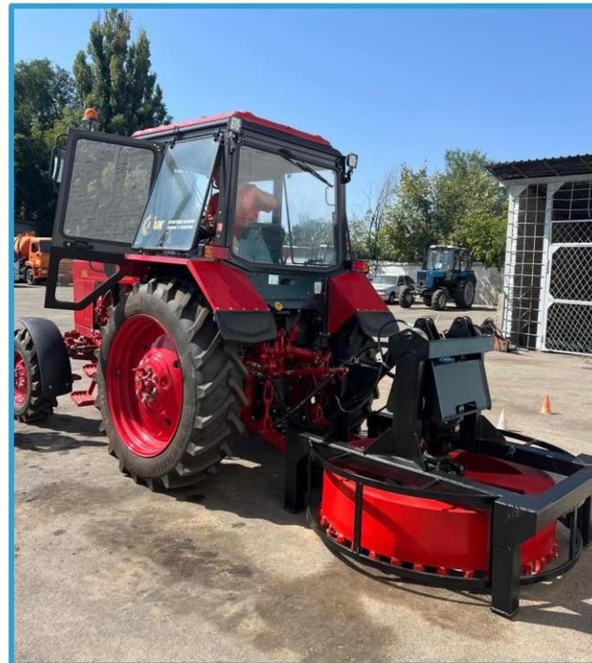
Трактор с навесным оборудованием (фреза для вырезания люков)
